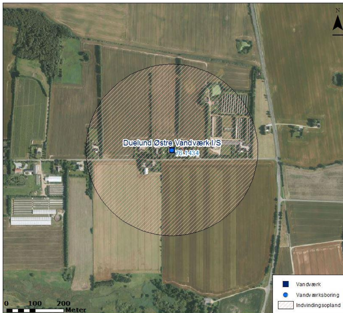
Figur 3.2 Duelund Østre Vandværks indvindingsopland med placering af vandværket, borer og V1 og V2 kortlagte lokaliteter.
