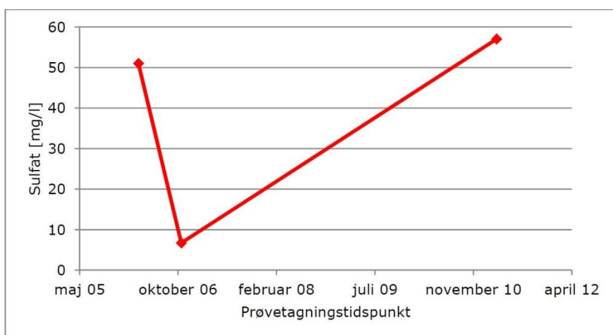
Figur 5.2 koncentrationen af sulfat i råvandet fra boring DGU nr. 76.1434 i perioden 2006 til 2011.
